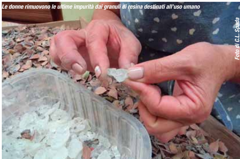
Le donne rimuovono le ultime impurità dai granuli di resina destinati all'uso umano
