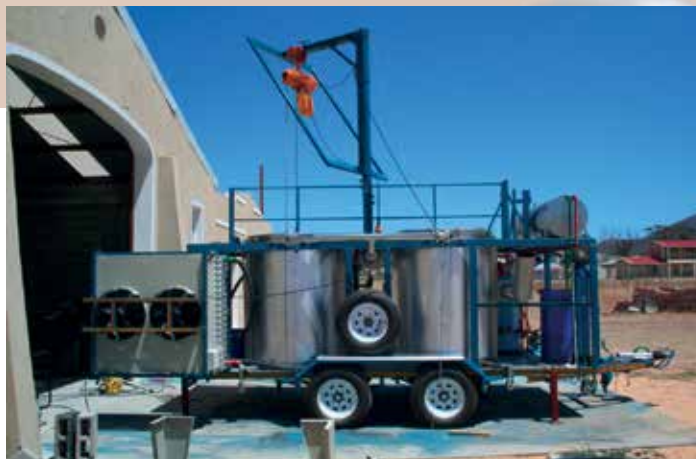
Figura 1 Impianto mobile per la distillazione in campo di oli essenziali operativo in Sud Africa: capacità di lavoro di circa 3 tonnellate/giorno di materiale vegetale ( \pm 280kg/ora). Foto di Mister Sandor Kocsis, gentilmente autorizzata per la pubblicazione ( www.edesa.co.za ; www.stillpure.co.za ).
