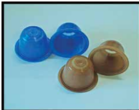
Figura 4. Esempio dei film sottili biodegradabili e compostabili realizzati per imballaggio alimentare.
