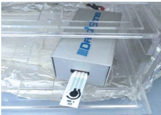
Figura 1. Elettrodo con modifica utilizzato per la valutazione del potere antiossidante.
